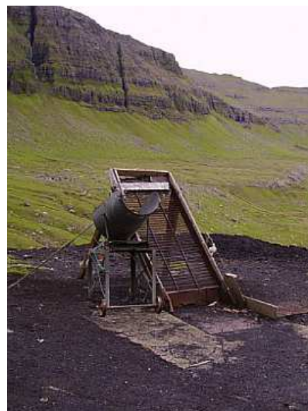
Kohlenwaage mit Schüttelsieb
